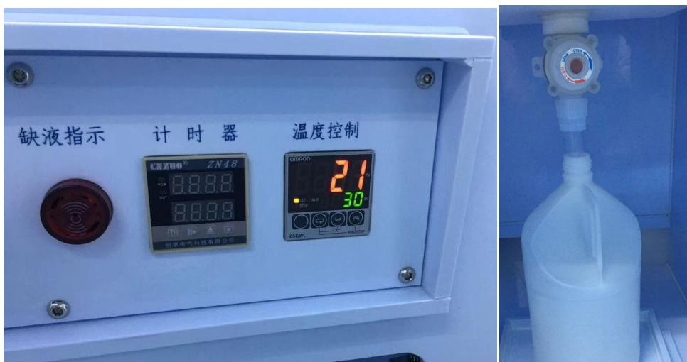
6.10 逆时针旋转开关，液体开始流出，液面达到八分满时，顺时针关闭排液管，轻敲废液管口，有表面张力，或在下边铺上吸液棉将粘上的废液敲下，倾斜着取出废液桶（**切勿将液体洒出**）
