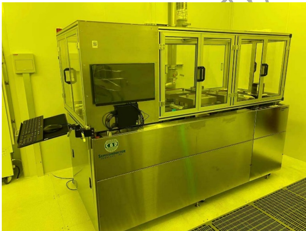
自动涂胶显影机 P8000 主机器
